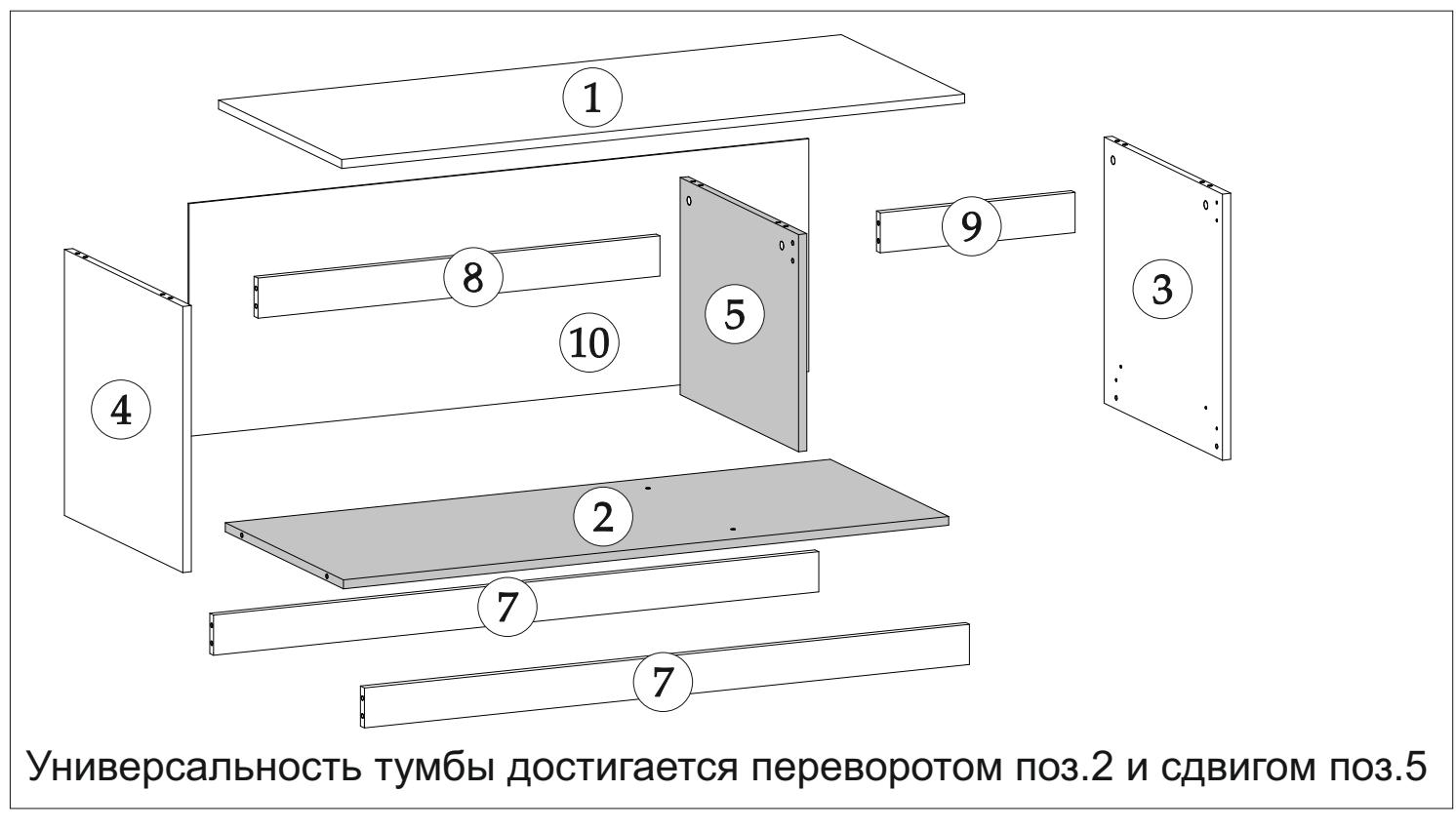
Универсальность тумбы достигается переворотом поз.2 и сдвигом поз.5
