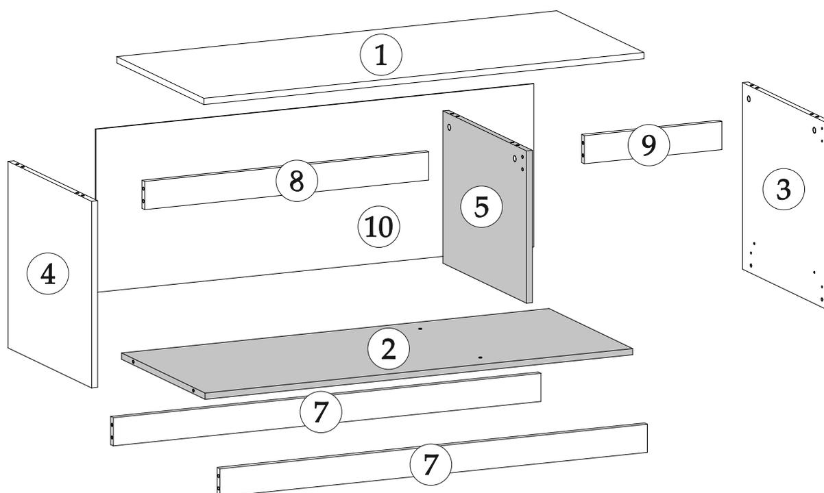
Универсальность тумбы достигается переворотом поз.2 и сдвигом поз.5
